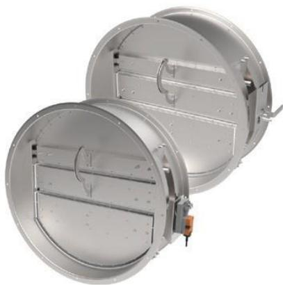
Клапан КВ (аналог НЕРПА) - это воздушные клапаны высокой плотности (класс уровня протечки 2), с увеличенной жесткостью конструкции корпуса и лопаток, разработанные для регулирования приточного, рециркуляционного или вытяжного воздуха в системах вентиляции высокого давления в условиях резких скачков перепада рабочего давления в сети, которое может достигать 10000 Па.
